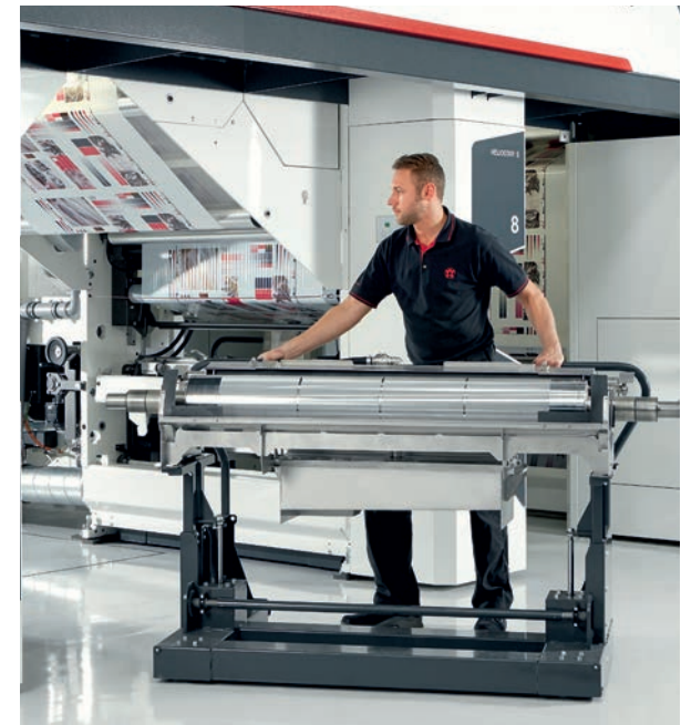
Wechsel des Druckzylinders zusammen mit der Farbversorgung
