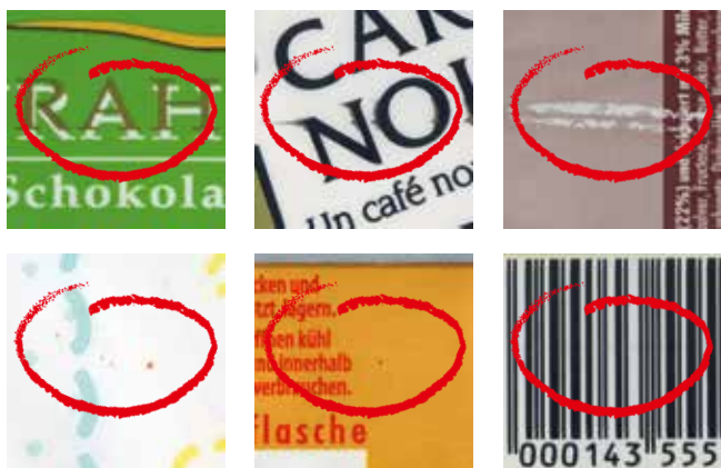
颜色点、印刷偏差、纸张上的异物等缺陷都可以被系统精准的检出并分类
