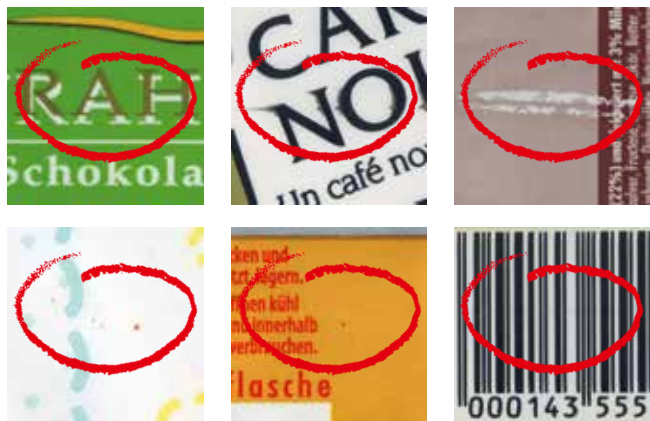
Fehler wie Farbflecken, Druckabweichungen, Einschlüsse im Papier oder Verunreinigungen werden von den Inspektionssystemen von ISRA zuverlässig detektiert und klassifiziert.
