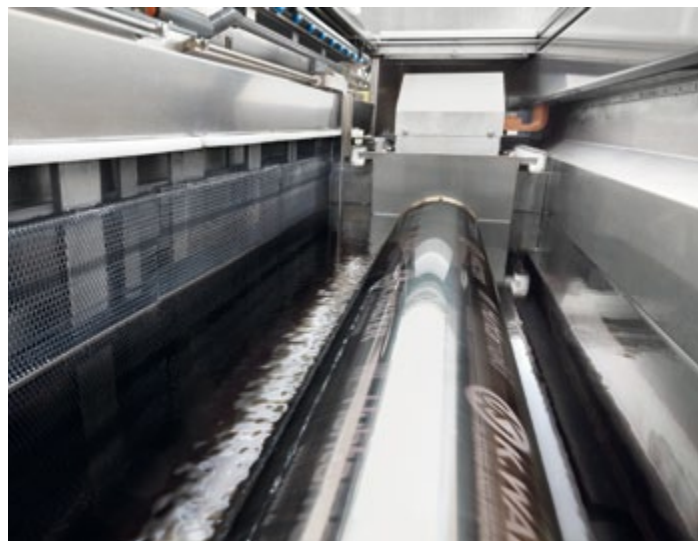
| Tiefdruckzylinder-Verchromung mit Helio Chrome NEO
