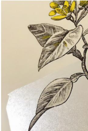
Als Designfarben werden natürlich wirkende Sonderfarben ausgewählt und mit den Farbtönen der beiden Heißfolien abgestimmt. Der Druckjob wird mittels nur drei Sonderfarben realisiert. Zur Optimierung der Prozessstabilität und Erhöhung der Brillanz der finalen Verpackung wird bei der Farbauswahl darauf geachtet, dass möglichst ohne Halbtöner produziert werden kann.
