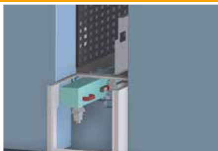
Installazione modulo interdeck GST/UV mod. D GST/UV interdeck module mod. D installation
