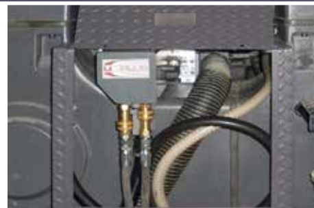
Installazione modulo interdeck GST/UV mod. D GST/UV interdeck module mod. D installation
