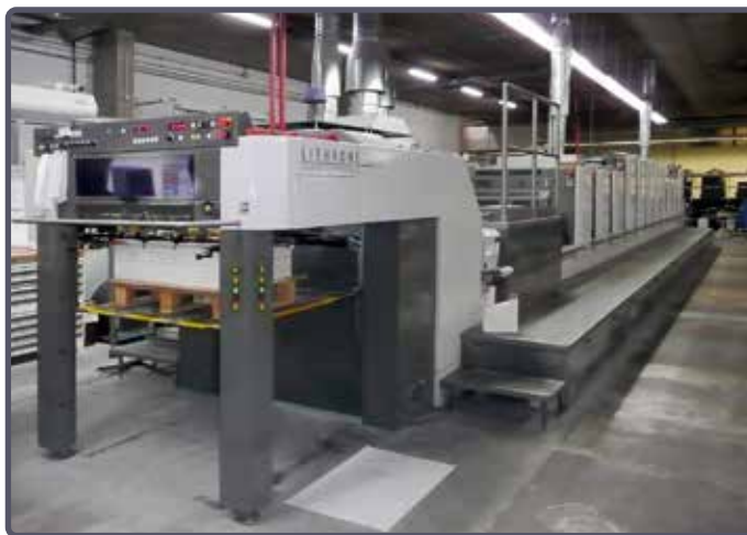
Forni GST/V + I.R.-A.C. su Komori LSX 629 + 3 L + 2 D.U. + X GST/UV + I.R.-HOT AIR dryers on Komori LSX 629 + 3 Coaters + 2 D.U. + X
