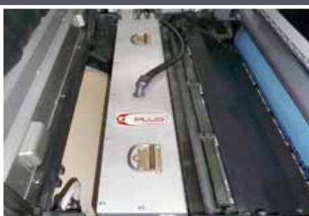
Installazione modulo GST/UV interdeck mod. D GST/UV interdeck module mod. D installation
